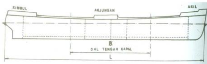
Gambar 5.3. Panjang efektif kapal
